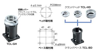
HSK E型/F型のようなドライブキー溝やU溝のないツール用のクランパとして、TCL-GHクランパをご使用下さい。 Vフランジ径さえ同一なら異なるシャンクもクランプ出来ます。例)TCL-63GH(HSK63A, 63E, 63F, BT40, NC5-63) クランパベースは共通で、クランパヘッドを交換することにより各種シャンクに対応出来ます。
