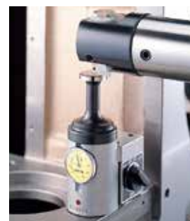
ボーリングバーの微調整用としても使用できます。
