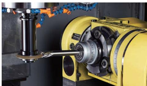
■NC研削盤や汎用研削盤上で、刃具振れを調整するのに最適です。
