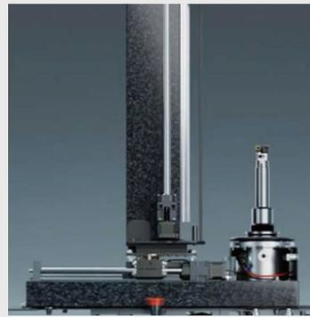
天然グラナイトは地球上で最も熱膨張率が低い天然素材の1つで、温度や湿度に左右されず抜群の寸法安定性を発揮、高い剛性や耐摩耗性、耐腐蝕性を誇ります。E68CX/E46CXは、この天然グラナイトをコラム部、及びベース部に採用。高い精度と信頼性を誇る自社開発の光学スケールを直付けする独創的な手法により、測定環境の変化に対しても常に安定した測定性能を維持することが可能です。
