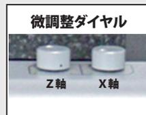
\* E46CXのマニュアル測定時におけるX軸Z軸の移動は、軸移動ハンドルで行います。
