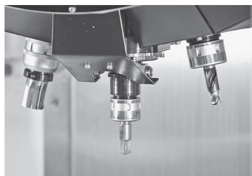
コーリツはMGカバーを加工する自動化ラインに日研工作所の黒のホルダを導入
