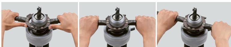
3ステップの簡単操作で、ミーリングチャックを簡単・安全に締め付け、または緩められます。
