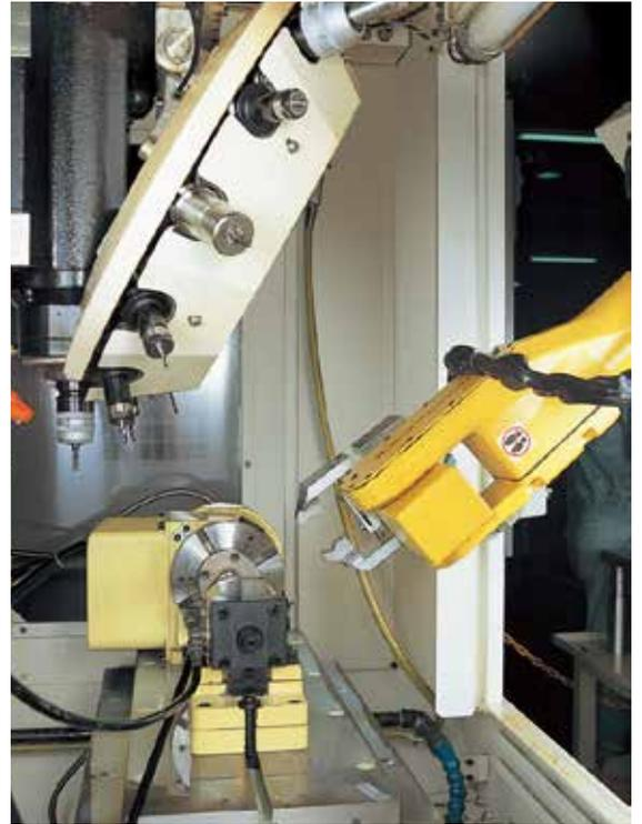
■ 多種類のワークにもフレキシブルに対応。CNC円テーブルとの結合部はセンチュリ型ホルダ(端面密着式)で標準化し、ワークを取付る先端部は、ワークに合わせ最適化、複数取付が行えるシステムです。又、ホルダにIDを取付してワークの自動選別も行えます。
