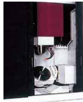
金型加工用M/Cの5軸テーブルとしての採用
