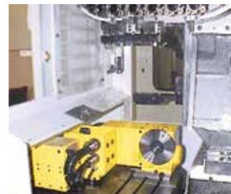
小型タッピングセンタのパレットチェンジャにCNC円テーブル2台と中継ボックスを搭載
