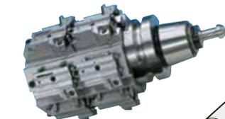
小物部品の多面取付、多面加工
