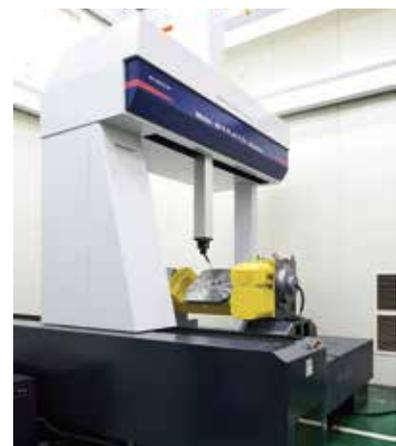
大型3次元測定器による割出精度測定
