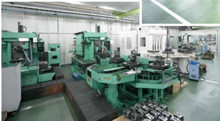
室温 $20.5^{\circ}\text{C} \pm 0.5^{\circ}$ に温度管理された恒温室で、最終仕上加工を行ないます。超精密加工用に、オーダメイドで製作した超高精度M/Cがヨーロッパ製治具ボーラと共に、効果を発揮しています。
